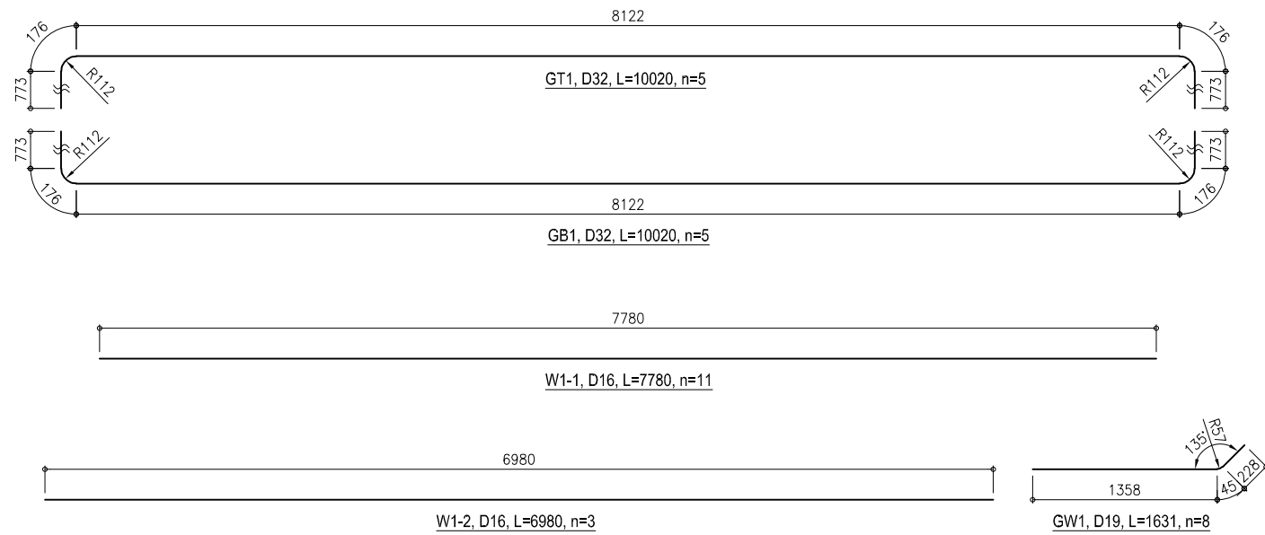
REBAR DETAIL / CHI TIẾT THÉP SCALE: 1/50
